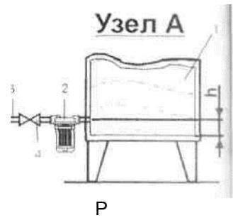
ис. 32.2. Рис. 32.2.: 1 - расходный топливный бак; 2 - топливный фильтр расходного топливного бака; 3 - труба топливопровода, соединяющего расходный топливный бак с топливным насосом жидкотопливной горелки котла; 4 - топливный кран.
